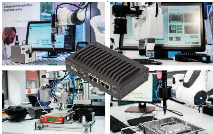
Der Embedded-PC TQ MBox-ADV ist als intelligenter Knotenpunkt universell einsetzbar und kann beispielsweise einen Cobot inklusive Peripherie koordinieren und dabei unter anderem Daten für Qualitätssicherung und Material-Dispo erfassen.
