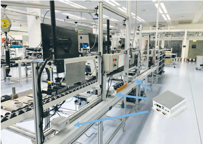
TQ setzt auch bei der Produktion der „Panda“-Cobots von Franka-Emika die modular aufgebaute MBox-R als Edge-Controller zur Prozessdatenerfassung, Qualitätssicherung und Visualisierung ein. (Bild: TQ-Systems)
