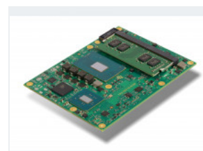
Highend-COM-Express-Basic-Modul TQMx70EB mit Intel-Core-Prozessoren der 7. Generation (Kaby Lake-H) und bis zu 32 GByte DDR4-2400-Speicher. (Bild: TQ-Systems)
