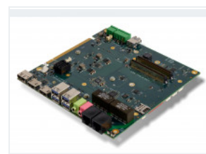
Medical Grade Carrierboard MB-COME6-2, das als Basis für Medizinanwendungen in patientennaher Umgebung gemäß DIN EN/IEC 60601-1 und DIN EN/IEC 60601-1-2 verwendet werden kann. (Bild: TQ-Systems)
